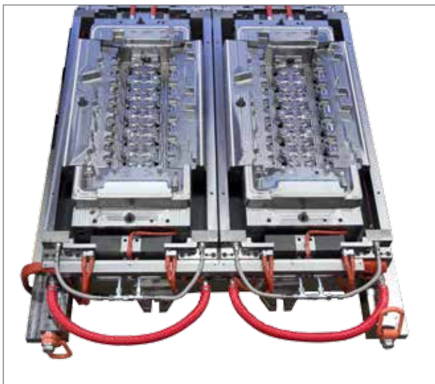
Das geöffnete Werkzeug UT mit allen Medienzuführungen und Schnittstellen (Schieber geöffnet).
