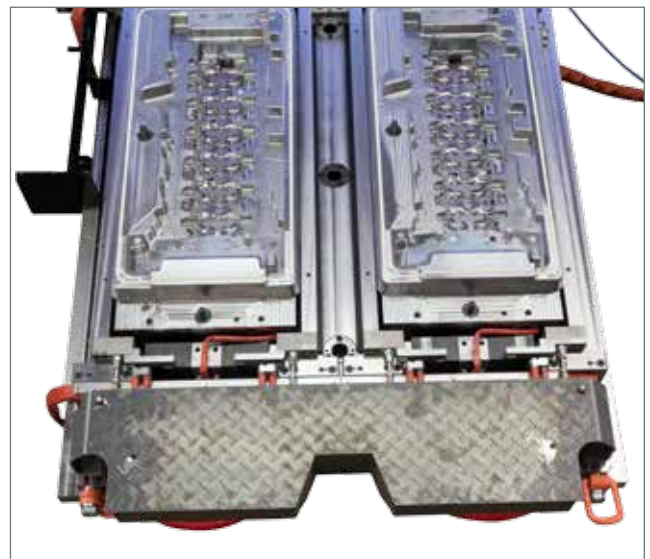
Das geöffnete Werkzeug UT mit der begehbaren Abdeckung zum Schutz der Medienzuführungen (Schieber geschlossen).
